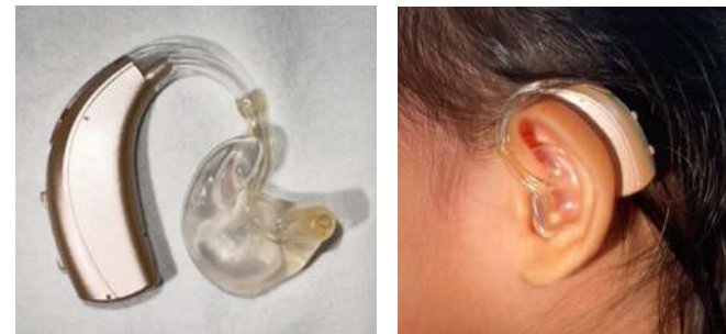
รูปที่ 7.1 เครื่องช่วยฟังแบบ BTE ขณะสวมใส่บนหูของเด็กเล็ก และพิมพ์หู (ear mold) ที่ต่อเข้ากับ BTE
